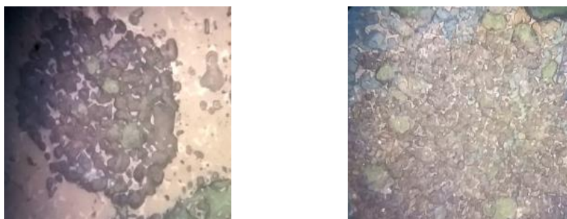
Рисунок 7 – Свободный оксид кальция, расположенный на внешних гранях кристаллической решётки
